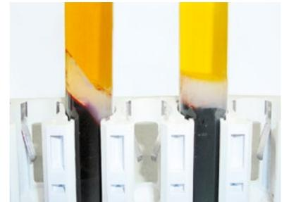
Trenngelröhrchen in Winkelkopfzentrifuge zentrifugiert, liegend transportiert. Erschütterungen können die labile, schräg liegende Gelbarriere öffnen.
