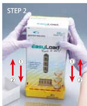
①外側フィルムを完全に押し下げると、チップがセットされます。②外側フィルムを元の位置に戻します。
