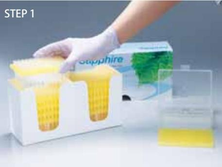
外側カバーを外し、リロードチップを取り出します。
