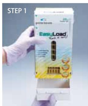
底面カバーを外します。専用ラックの中敷きを取り除いてリロードユニットをセットします。
