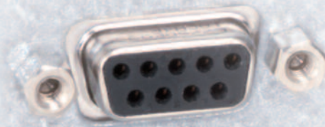
Port RS232 standard sur tous les modèles / tailles GP, AP et APS
